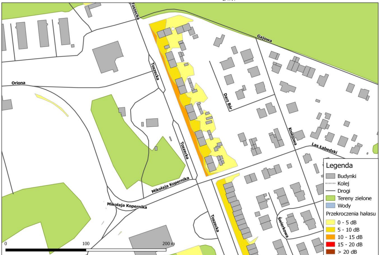
Rys. 3.3. Wycinek mapy przekroczeń poziomu hałasu pochodzącego od ruchu drogowego na terenie Miasta Gliwice - wskaźnik L_{DWN}
