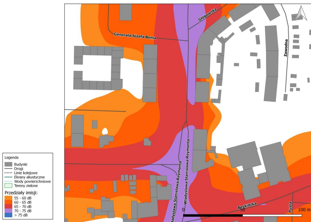
Rys. 8.34. Mapa imisji dźwięku – wskaźnik L_{dwn} , ul. Władysława Reymonta na odcinku od ul. Głogowskiej do ul. Beskidzkiej, po zastosowaniu działań naprawczych
