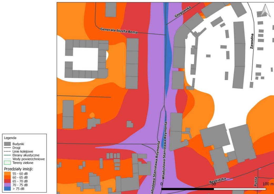
Rys. 8.33. Mapa imisji dźwięku – wskaźnik L_{dwn} , ul. Władysława Reymonta na odcinku od ul. Głogowskiej do ul. Beskidzkiej, przed zastosowaniem działań naprawczych
