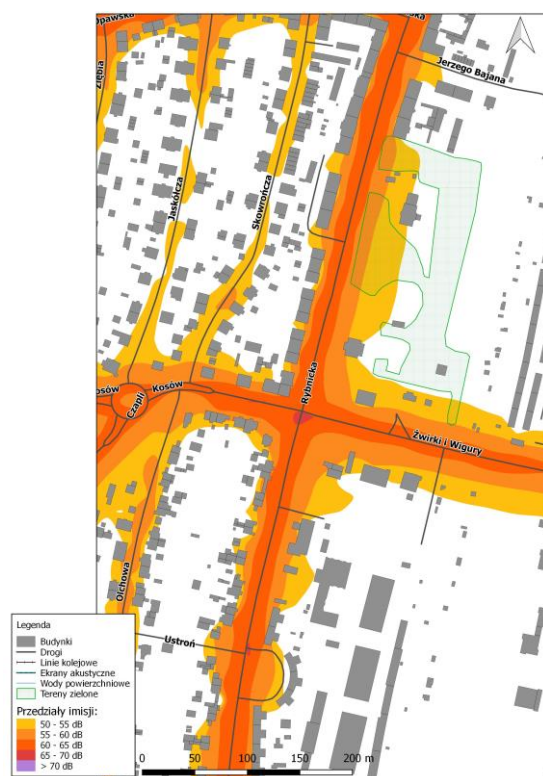
Rys. 8.44. Mapa imisji dźwięku – wskaźnik L_N , ul. Rybnicka na odcinku od ul. Żurawiej do ul. Kochanowskiego, po zastosowaniu działań naprawczych
