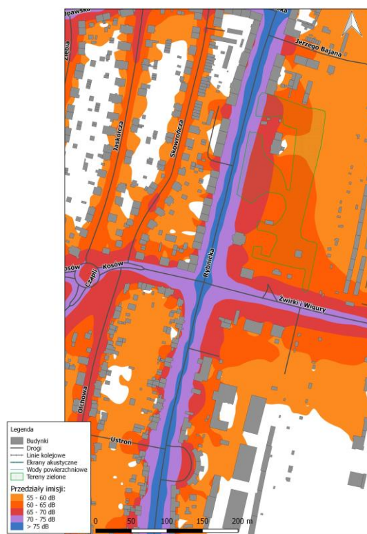
Rys. 8.41. Mapa imisji dźwięku – wskaźnik L_{dwn} , ul. Rybnicka na odcinku od ul. Żurawiej do ul. Kochanowskiego, przed zastosowaniem działań naprawczych
