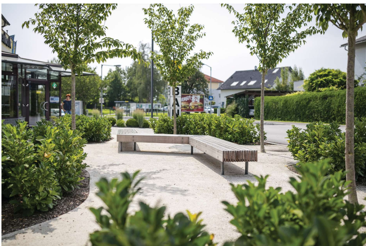
2.2.1.2 Ławki bez oparcia – drewno sosnowe lub robiniowe, konstrukcja stalowa, ocynkowana, malowana proszkowo.
